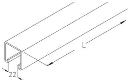
С-профиль 41x41x2.50 мм, неперфорированный, ширина шлица 22 мм
