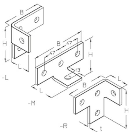
**Горячеоцинкованная методом погружения, по DIN EN ISO 1461**
