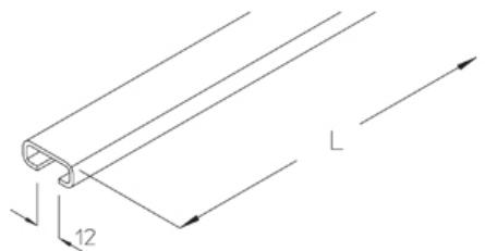
С-профиль 28x12x2.00 мм, неперфорированный, ширина шлица 12 мм
