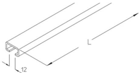
С-профиль 28x15x2.30 мм, неперфорированный, ширина шлица 12 мм
