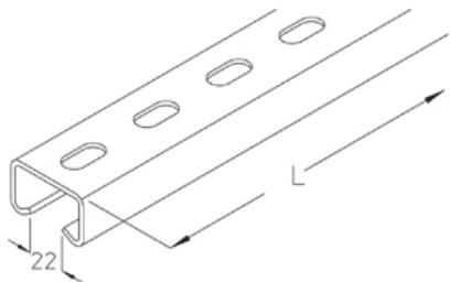
С-профиль 50x31 мм, размер перфорации 13x26, ширина шлица 22 мм
