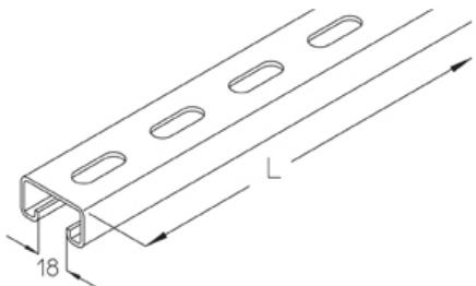
С-профиль 40x22x2.00 мм, размер перфорации 11x30, ширина шлица 18 мм
