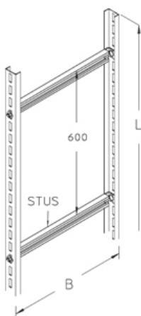
Вертикальный лоток для средних нагрузок, с перфорированными боковыми профилями, для монтажа к стене, сборные перекладины 40x22 мм
