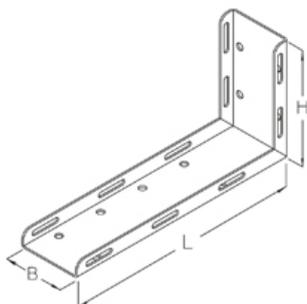
Горячецинкованная методом погружения, по DIN EN ISO 1461
