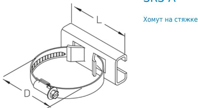
Горячекатаная методом погружения, по DIN EN ISO 1461
