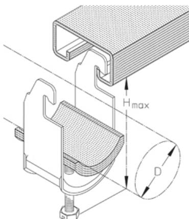
Кабельный зажим, оцинкованный, с поддерживающей пластиной из стали и дополнительной пластиковой прокладкой Для крепления к С-профилям шинам с шириной шлица 18/22 мм.
