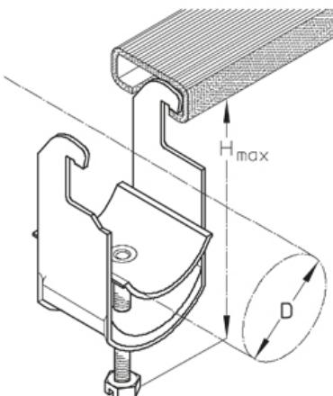
Кабельный зажим, из нержавеющей стали, с поддерживающей пластиной Для крепления к С-профилям шинам с шириной шлица > 10 мм.
