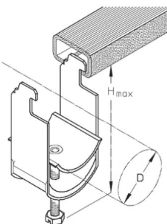
Кабельный зажим, оцинкованный, с поддерживающей пластиной из стали Для крепления к С-профилям шинам с шириной шлица 11 мм.
