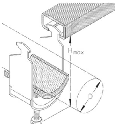
Кабельный зажим, оцинкованный, с поддерживающей пластиной из стали и дополнительной пластиковой прокладкой Для крепления к С-профилям шинам с шириной шлица 11 мм.
