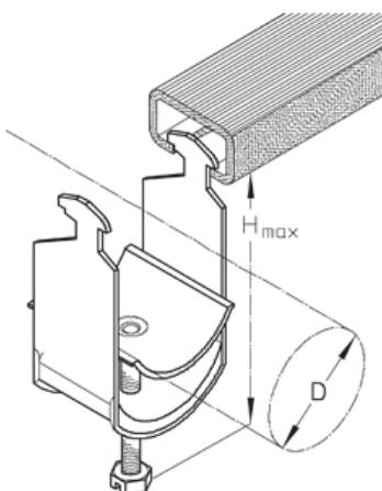
Кабельный зажим, оцинкованный, с поддерживающей пластиной из стали Для крепления к С-профилям шинам с шириной шлица 11 мм.
