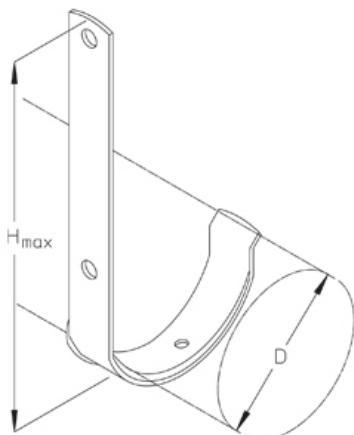
Кабельный крюк, оцинкованный, для кабелей диаметром до 100 мм
