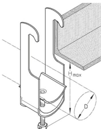
Кабельный зажим, оцинкованный, с поддерживающей пластиной из стали Для крепления к угловым профилям до 40 мм
