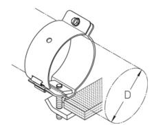
хомут для крепления ВЧ-кабеля, для профилей из плоской стали
