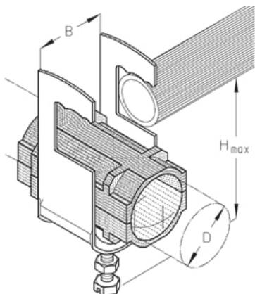
Кабельный зажим для ВЧ-кабеля, оцинкованный, с поддерживающей пластиной из стали, и пластиковыми ложементами, Для крепления к круглым и плоским профилям до 22 мм
