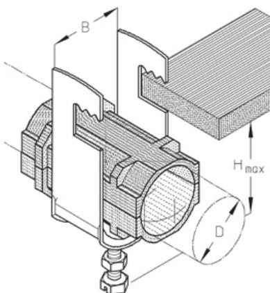
Кабельный зажим для ВЧ-кабеля, оцинкованный, с поддерживающей пластиной из стали, и пластиковыми ложементами, Для крепления к плоским профилям до 12 мм
