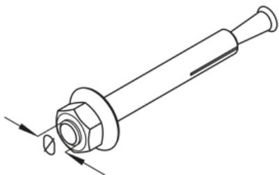
Допускается одинарное крепление. Допустимая нагрузка в нормальном бетоне с трещинами и без трещин с прочностью  $\geq C20 / 25$ . Строго соблюдайте информацию производителя (ETA-06/0175).
