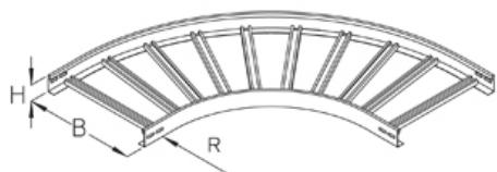
Угол внутренний, высота=60 мм Огнестойкие кабельные линии - стандартные несущие конструкции
