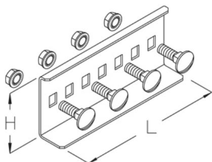
соединитель, высота=60 мм Огнестойкие кабельные линии - стандартные несущие конструкции
