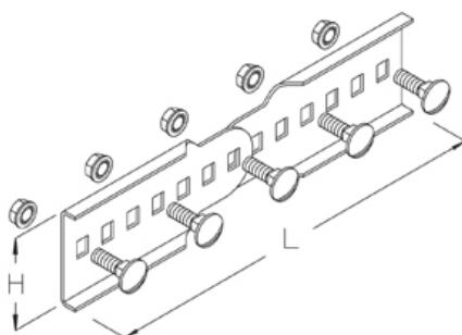
Соединитель, вертикальный, высота=60 мм Огнестойкие кабельные линии - стандартные несущие конструкции
