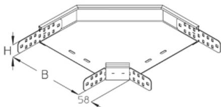
Угол горизонтальный, 90°, для горизонтальной смены направления, с интегрированными соединителями
