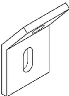
Крепежный уголок Огнестойкие кабельные линии - стандартные несущие конструкции
