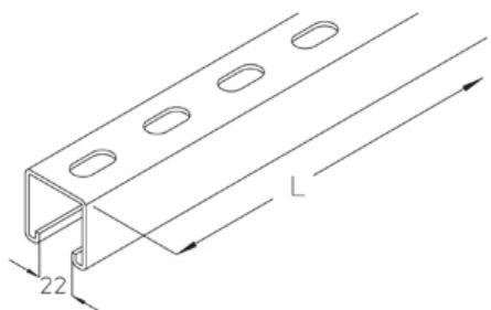
С-профиль 41x41 мм, перфорированный Огнестойкие кабельные линии - стандартные несущие конструкции
