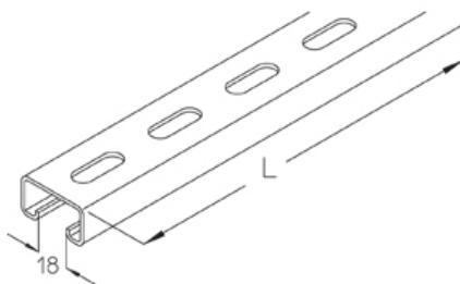
С-профиль 39.5x22 мм, перфорированный Огнестойкие кабельные линии - стандартные несущие конструкции
