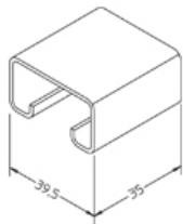
Усиливающая вставка, KHU 40 Огнестойкие кабельные линии - стандартные несущие конструкции
