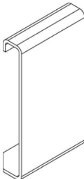
Усиливающая вставка, KHU 60 Огнестойкие кабельные линии - стандартные несущие конструкции
