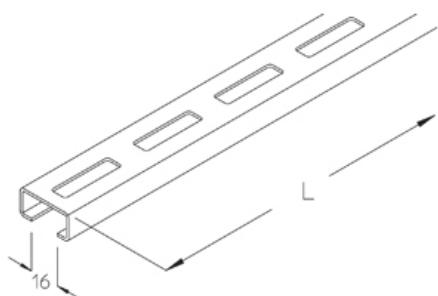
С-профиль 30x15 мм, перфорированный Огнестойкие кабельные линии - стандартные несущие конструкции
