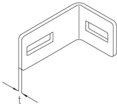
Крепежный уголок, LGG 60/STU-BS 50 Огнестойкие кабельные линии - стандартные несущие конструкции
