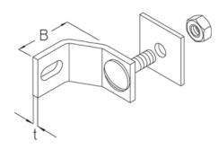
Крепежный уголок, ST-BS 81 Огнестойкие кабельные линии - стандартные несущие конструкции
