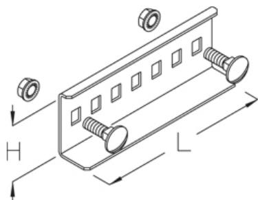
Соединитель, высота=50 мм
