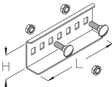
соединитель, высота=60 мм
