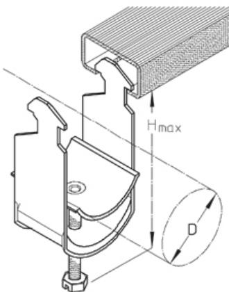
Кабельный зажим, крепёжные принадлежности для профиль-шин Огнестойкие кабельные линии - стандартные несущие конструкции
