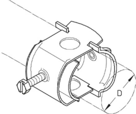
Кабельный зажим, настенные крепёжные принадлежности Огнестойкие кабельные линии - стандартные несущие конструкции
