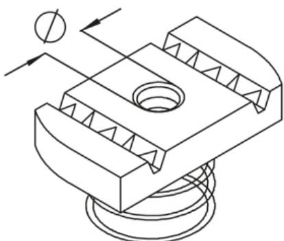
анкерная гайка с пружиной, А 7/ А 8
