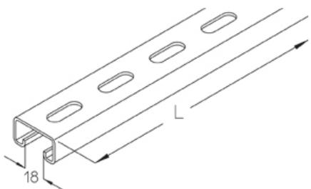
С-профиль 40x22 мм, перфорированный Установка на эвакуационных путях и выходах
