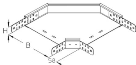
Угол горизонтальный, 90°, для горизонтальной смены направления, с интегрированными соединителями
