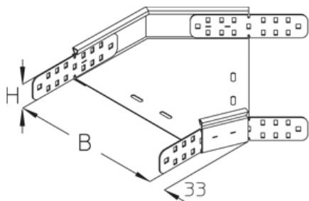
Угол горизонтальный 90°, высота=60 мм Установка на эвакуационных путях и выходах
