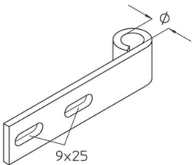
Адаптер консоли Установка на эвакуационных путях и выходах
