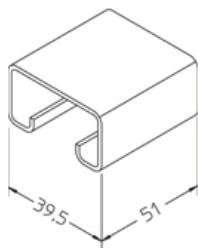
Усиливающая вставка, KHUSS 57 Установка на эвакуационных путях и выходах
