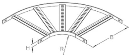
Горизонтальный угол 90°, предназначен для горизонтального изменения направления судового лестничного лотка
