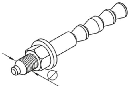
Допускается одинарное крепление Допустимая нагрузка в нормальном бетоне с трещинами и без трещин с прочностью  $\geq C20 / 25$ . Строго соблюдайте информацию производителя (ETA-05/0164).
