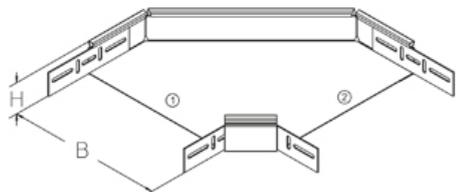
Угол листового лотка, горизонтальный 90°, со встроенными соединителями
