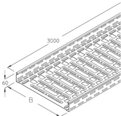
Листовой лоток легкий, перфорированный, с формой борта для защёлкивания крышек, с продольными и поперечными ребрами жесткости для уменьшения прогиба пола, испытан в соответствии с DIN EN 61537, включая электр. проводимость Легкий кабельный лоток с перфорацией 30% для использования с спринклерными системами в соответствии с VdS 2092.
