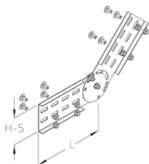
Все остальные углы до 90 ° можно установить с помощью имеющихся отверстий I. Это изделие может быть изготовлено из нержавеющей стали 1.4571 / 1.4404 (V4A)
