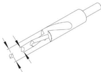
Ступенчатое сверло с плоской режущей кромкой для сверла D = 18мм
