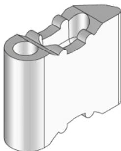
фиксатор для кабеля
