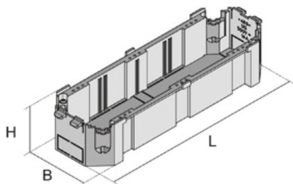
Черная пластиковая монтажная коробка, для установки в лючки. Состоит из цельного каркаса с фиксаторами кабеля и перфорированным дном. Предназначена для монтажа 3-х отдельных или 4-х совмещенных установочных модулей с защёлками и 2-х штекерных соединений.
